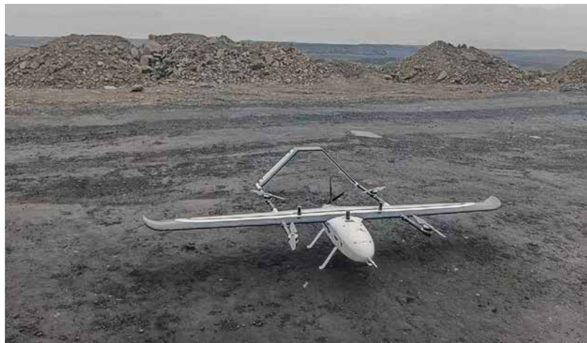
▲内蒙古第八地质勘查院使用V100固定翼无人机系统进行矿山边坡角度测量
