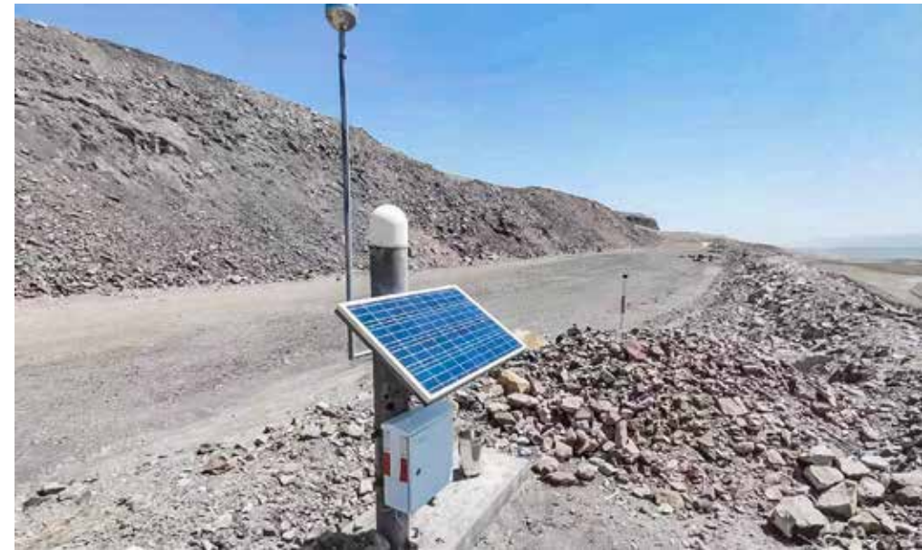
▲中海达GNSS监测设备监测矿山边坡
