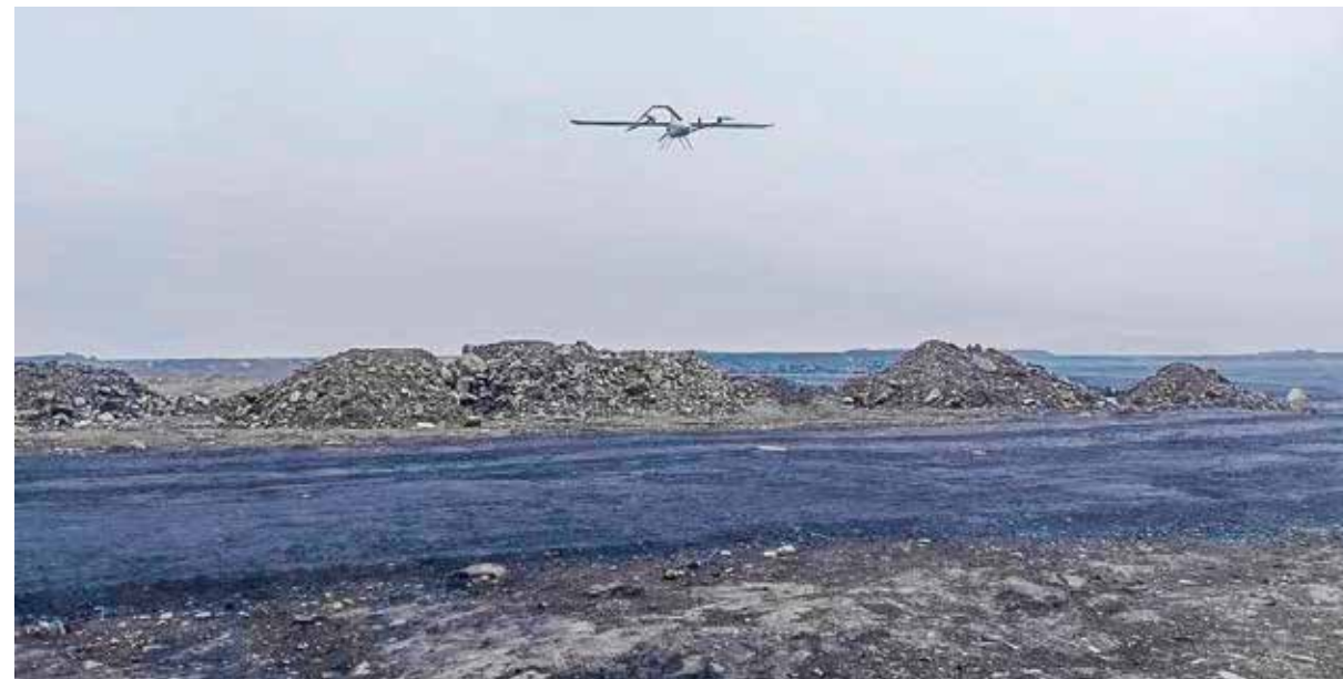
▲V100固定翼无人机系统开展矿山边坡角度测量的作业现场
