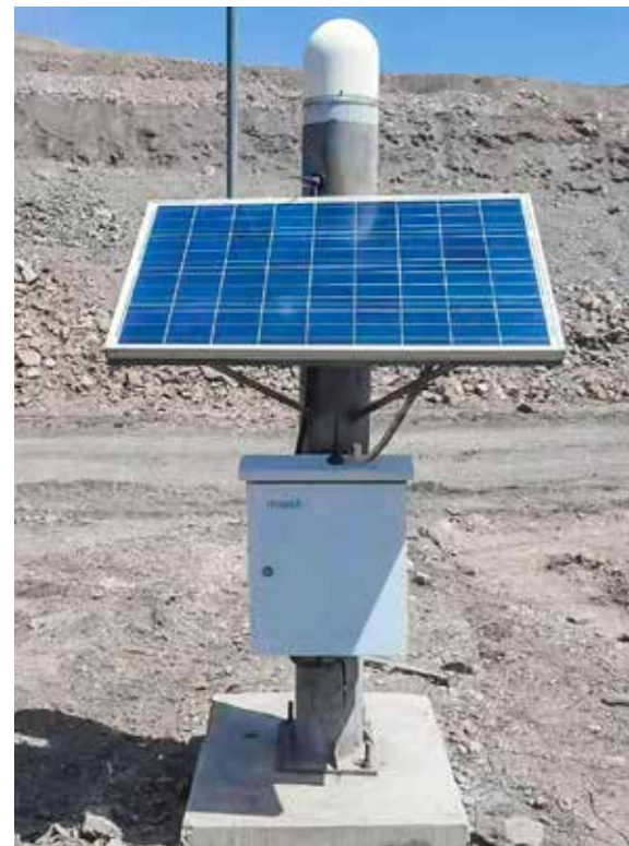
▲固定式观测墩中海达 GNSS 边坡监测站
