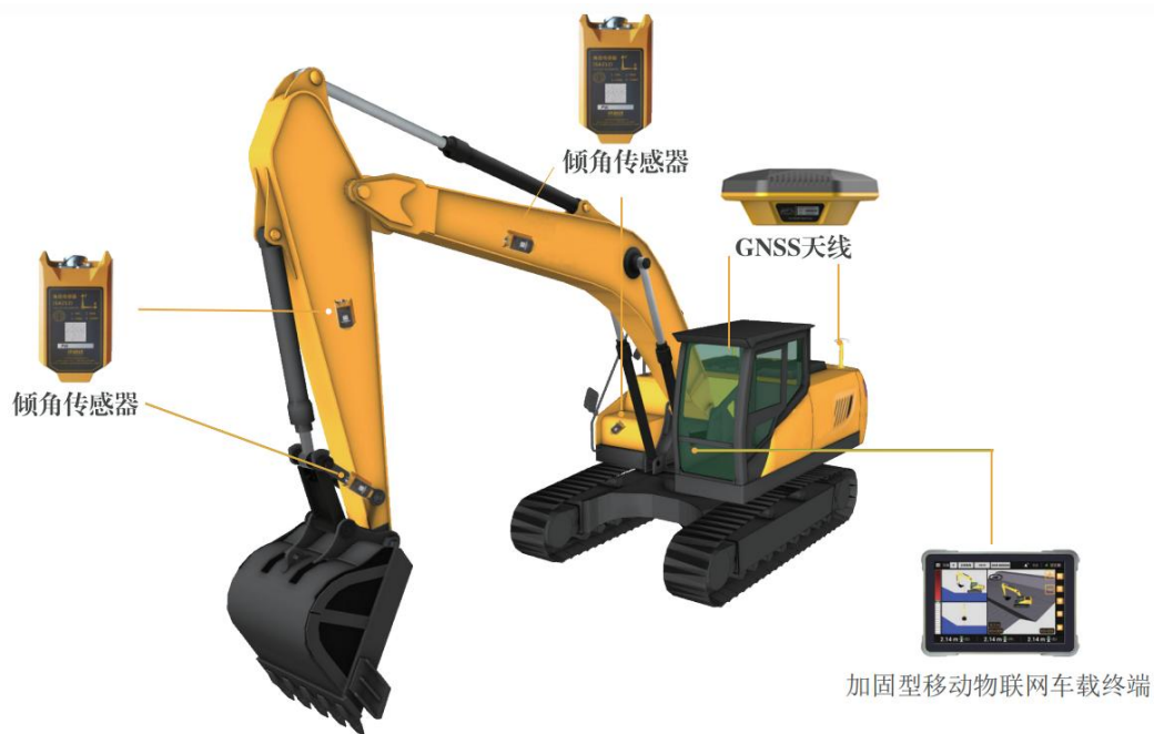
中海达ECS900挖掘机3D引导系统
