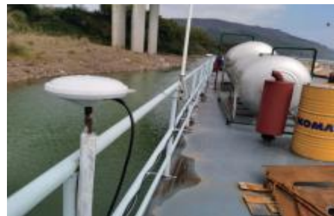
船上安装K20设备图(搭配中海达Hi - MAX软件使用)
