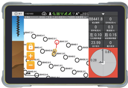
车载终端平板桩点位置校准
