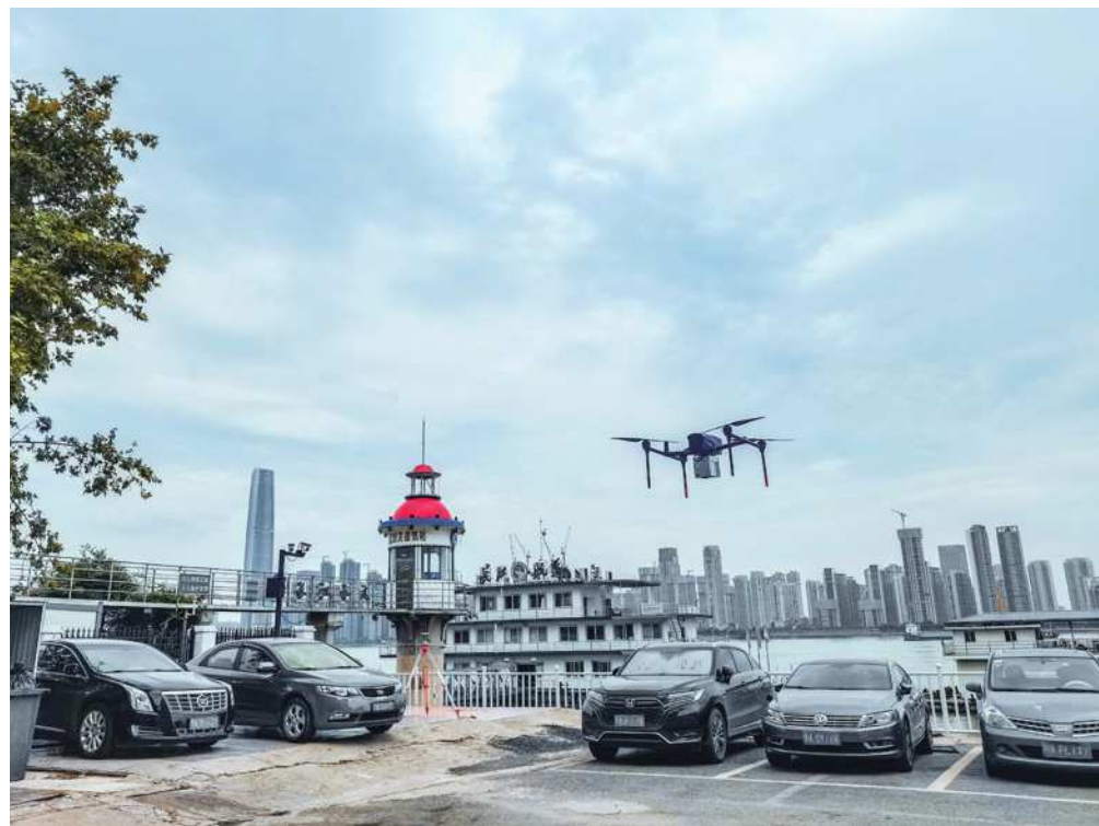
▲机载激光雷达在长江开展河道测量
