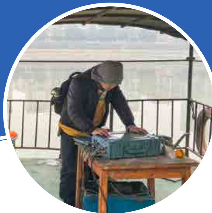
四川地勘局测绘二院作业人员使用中海达HD-370开展水下测量
