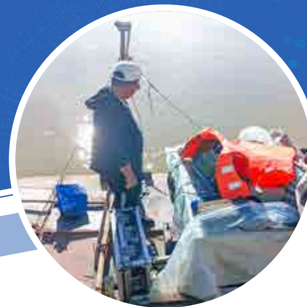
内蒙古水利勘测院作业人员使用中海达 HD-MAX 开展水下测量
